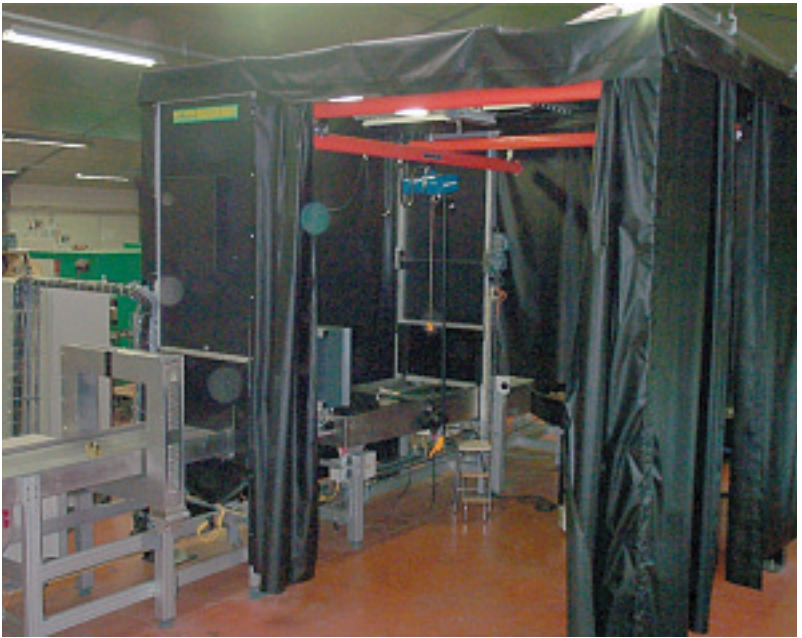
En reliant la machine à un convoyeur, il est possible de réaliser un contrôle magnétoscopique de pièces en défilement.
