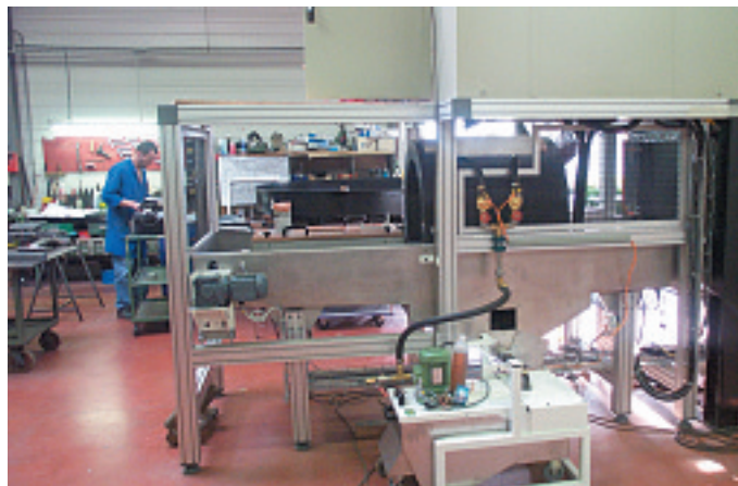
Cette machine, développée par Srem Technologies, met en œuvre un nouveau procédé de contrôle magnétoscopique. La méthode permet de détecter les défauts de tout type de pièce ferromagnétique (y compris les pièces de forge) et de réduire le risque d'arc électrique présent dans la technique traditionnelle.
