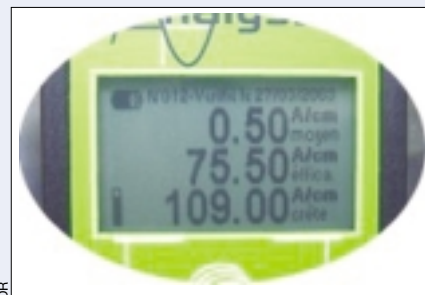
Affichage simultané des 3 valeurs sur mesureur de champ «Analyse».
