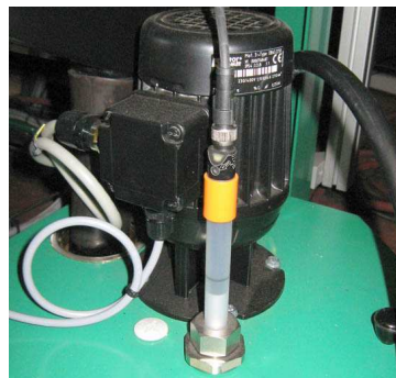
contrôle niveau pompe
