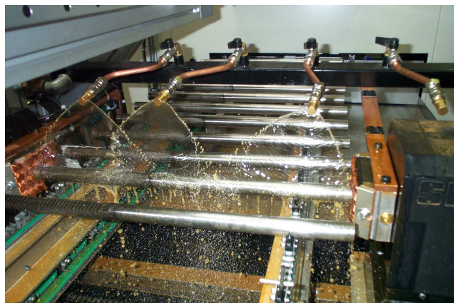
Contrôle de crémaillères - aimantation par champ tournant sur banc
