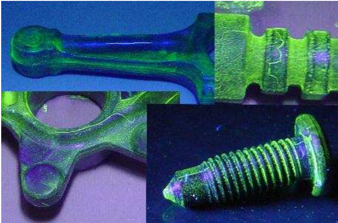
exemple de défauts révélés par magnétoscopie
