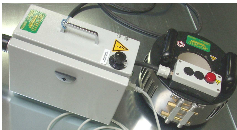
Adaptation d'un bobinage type DP110 par déport de la commande et limitation d'harmonique
