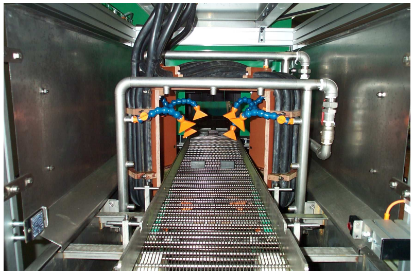
Magnétoscopie par champ tournant en chambre sans contact
