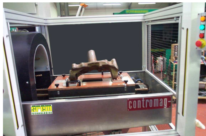
Banc de magnétoscopie avec système de magnétisation dynamique par courant induit
