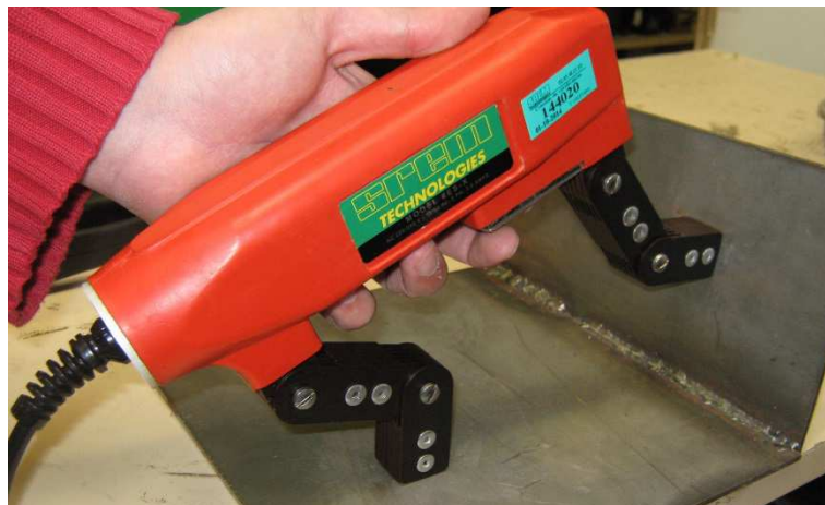
Mise en situation d'un électroaimant à bras articulés - version miniaturisée et portable des épanouissements polaires d'un banc de contrôle.
