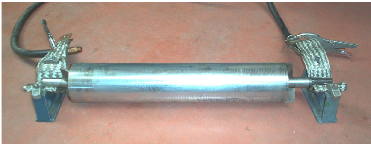
Mise en situation d'une aimantation par passage de courant dans une pièce.
